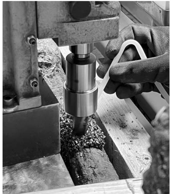
*Entnahme eines Metallbohrkerns bei der Magdeburger Firma DeltaSigma durch Mitarbeiter der Materialprüfanstalt (Foto: Jan F. Kegler, Ostfriesische Landschaft).*
