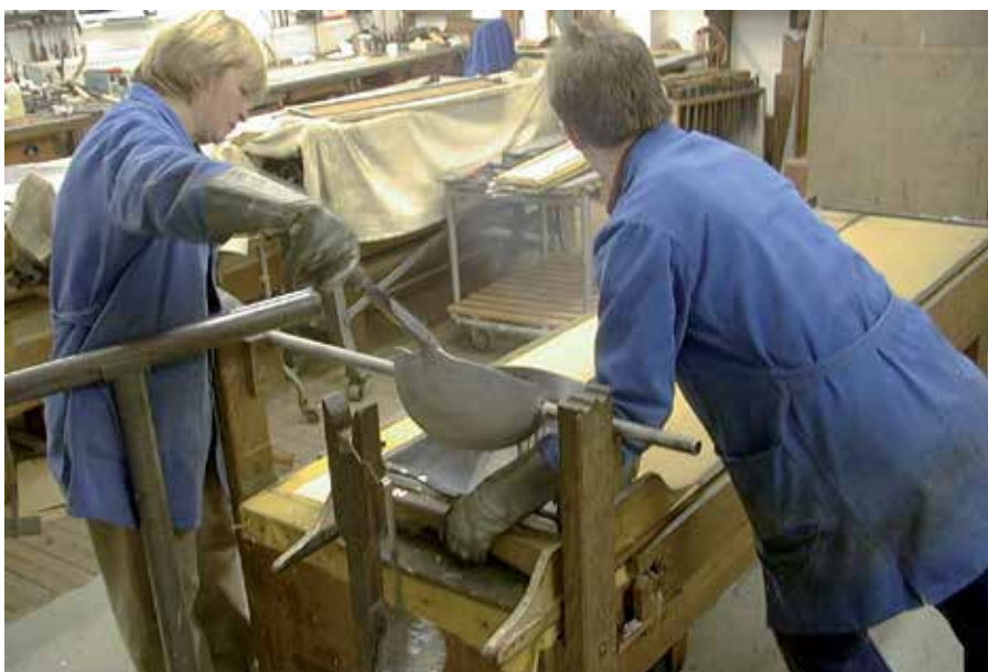
Gießen der Zinnplatten zur Pfeifenherstellung Foto: Orgelbauwerkstatt Ahrend
