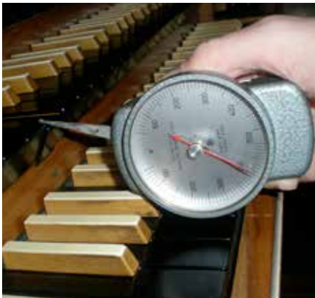
Bis zu 500g Kraftaufwand sind erforderlich, um eine Taste zu drücken
