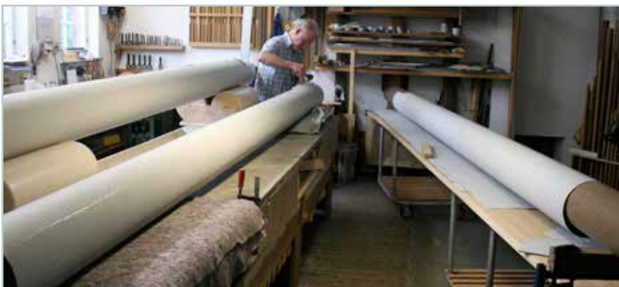
Abbildung oben: Ende 2016: Die neuen Bälge im Bau; links: Lötten der größten Pfeifenkörper im Mai 2018
