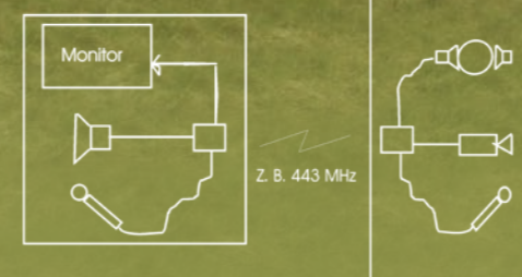
Nebengebäude mit Monitor, Lautsprecher und Mikro für Gehbehinderte
